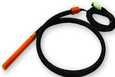
Вибратор состоит из вибронаконечника и пластиковым боксом с кнопкой выключателя, соединенных между собой резиноканевым рукавом.
