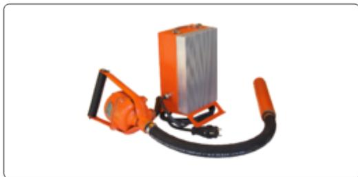
**Вибратор электромеханический глубинный ручной со встроенным электродвигателем ИБ-102А** предназначен для уплотнения бетонных смесей при укладке их в монолитные конструкции с различной степенью армирования в гидротехническом строительстве, а также при изготовлении бетонных и железобетонных изделий для сборного строительства с шагом между стержнями арматуры не менее 1,5 диаметра вибронаконечника.
