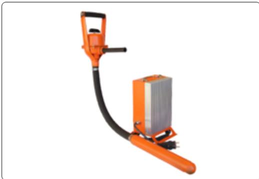
Вибраторы со встроенным электродвигателем состоят из вибронаконечника, коробки выключателя и соединяющего их резиноканевого рукава с расположенным в нем кабелем. В герметически закрытом корпусе вибронаконечника встроен трехфазный асинхронный электродвигатель с короткозамкнутым ротором, на валу которого находятся дебалансы, при вращении которых возникает вынуждающая сила.
