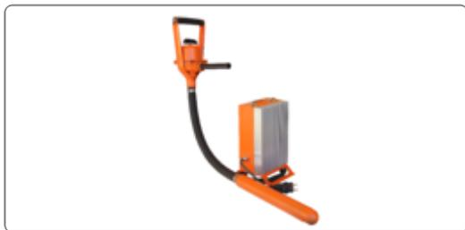
**Вибратор электромеханический глубинный ручной со встроенным электродвигателем ИБ-78** предназначен для уплотнения бетонных смесей при укладке их в монолитные конструкции с различной степенью армирования в гидротехническом строительстве, а также при изготовлении бетонных и железобетонных изделий для сборного строительства с шагом между стержнями арматуры не менее 1,5 диаметра вибронаконечника
