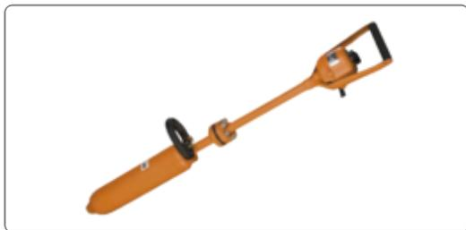
**Вибратор электромеханический глубинный ручной со встроенным электродвигателем ИБ-103** предназначен для уплотнения бетонных смесей при укладке их в монолитные конструкции с различной степенью армирования в гидротехническом строительстве, а также при изготовлении бетонных и железобетонных изделий для сборного строительства с шагом между стержнями арматуры не менее 1,5 диаметра вибронаконечника.
