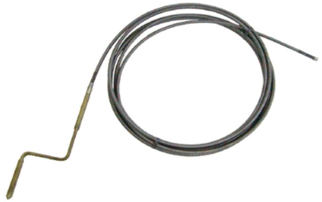
Гибкие валы представляют собой конструкцию навитой пружины проволоки, причем направление наливки слоев чередуется. Диаметр используемой для наливки проволоки и число слоев зависит от внешнего диаметра вала.
