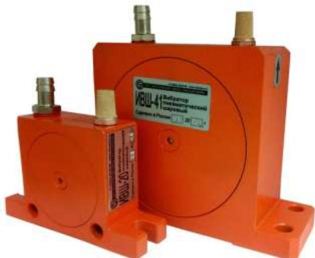
**Вибраторы пневматические шаровые ИВШ** предназначены для возбуждения вибрации в установках по уплотнению бетонных смесей, транспортированию, выгрузке и просеиванию сыпучих материалов, привода вибропитателей, виброплощадок и других технологических работ, в т.ч. для мини кирпичных блочных установок.
