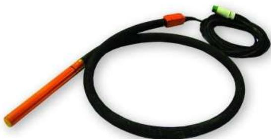
Включение вибраторов серии ИВАР осуществляется с помощью выключателя, расположенного в пластиковой коробке. Питание вибратора осуществляется от инвертора (мощность 1,5 кВт, входное напряжение 220В, частота тока 50 Гц, выходное напряжением 42 В, частота тока 200 Гц) или инвертора большей мощности, обеспечивающего номинальное напряжение при работе вибратора.
