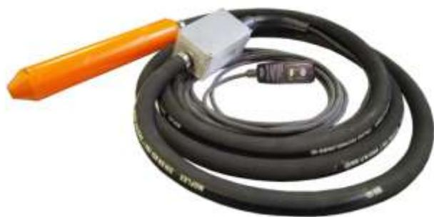
Вибратор электрический глубинный ручной со встроенным электродвигателем и встроенным инвертором, предназначен для уплотнения бетонных смесей при укладке их в монолитные конструкции с различной степенью армирования в гидротехническом строительстве, а также при изготовлении бетонных и железобетонных изделий для сборного строительства с шагом между стержнями арматуры не менее 1,5 диаметра вибронаконечника
