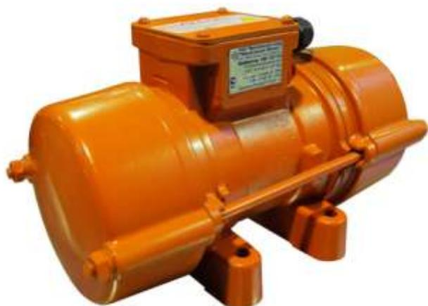
Предназначены для возбуждения вибрации в установках по уплотнению бетонных смесей и грунтов, транспортированию, выгрузке и просеиванию сыпучих материалов, привода вибропитателей, виброплощадок и других технологических работ, в т.ч. для мини кирпичных блочных установок.
