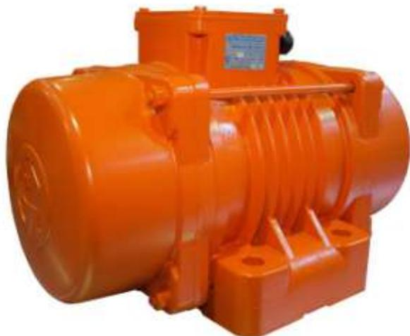
Предназначены для возбуждения вибрации в установках по уплотнению бетонных смесей и грунтов, транспортированию, выгрузке и просеиванию сыпучих материалов, привода вибропитателей, виброплощадок и других технологических работ, в т.ч. для мини кирпичных блочных установок.
