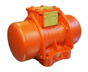
взрывозащиты вибратора «взрывонепроницаемая оболочка» ПО 51330.1-99. В вибраторе установлены специальные виброустойчивые роликовые подшипники ресурс работы: гарантирующие высокий Маркировка взрывозащиты 1ExdIIAT4 по ГОСТ Р 51330.0-99. По своим характеристикам – ресурсу и присоединительным размерам вибратор соответствует западным аналогам фирм Italvibras и Venancetti
