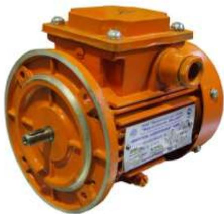
**Электродвигатели асинхронные трёхфазные с короткозамкнутым ротором серии 5А** имеют традиционную конструкцию закрытых обдуваемых машин с центробежным вентилятором наружного обдува и предназначены для привода насосов, вентиляторов, дымососов и других механизмов, не требующих регулирования частоты вращения. Двигатели работают в закрытых помещениях и на открытом воздухе, режим работы продолжительный, частота тока 50Гц. Двигатели данной серии имеют средний ресурс до 20000 часов.
